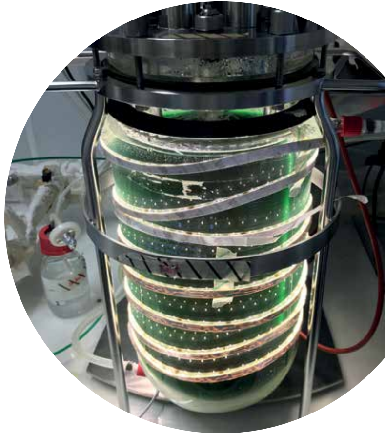
Abb. 2: Photobioreaktor, in dem Chlorella vulgaris auf Abfallströmen kultiviert wird, um Biodünger zu generieren und Wasser zu reinigen.
