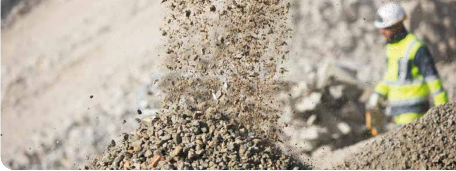
Beton wird zerkleinert und im Recycling Center Himberg zu Recyclingbeton verarbeitet.
