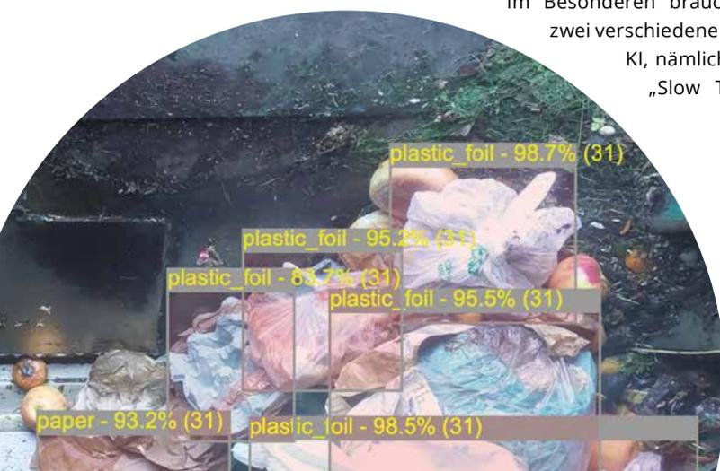
*Das Innere eines Müllsammelfahrzeugs: Im Bild sind verschiedene Mülltypen markiert – manche sind recyclebar, andere nicht. Das ist aber nur der Ausgangspunkt der Planung, denn darauf basierend müssen komplexe Entscheidungen für die Optimierung getroffen werden.*
